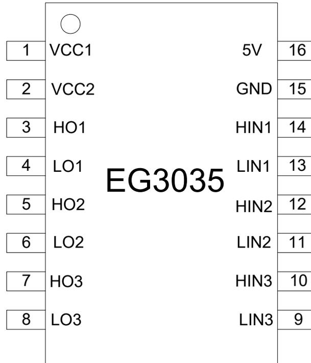
图 4-1. EG3035 SOP16 管脚定义
